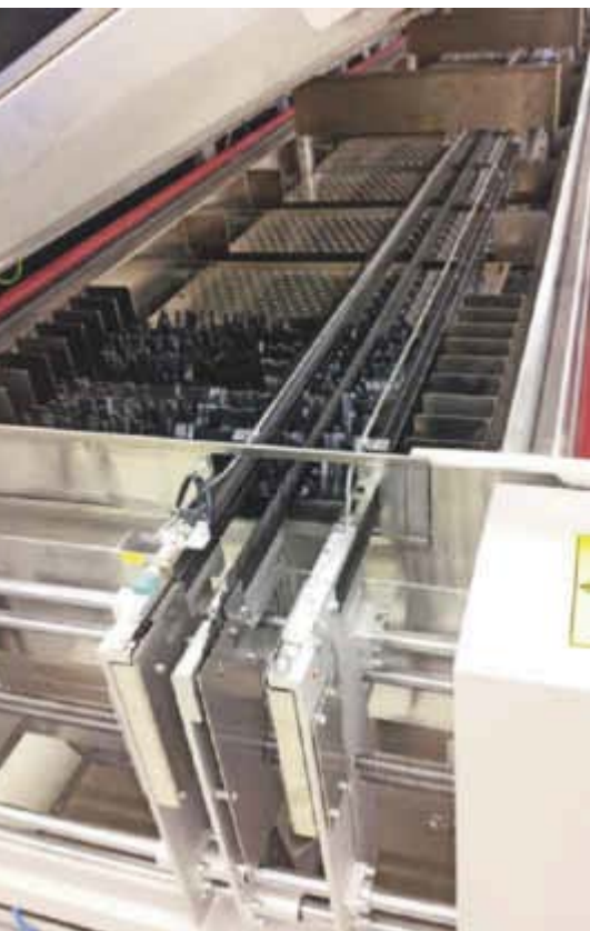
Mit dem neuen Messsystem werden weniger Thermopaar benötigt, was zu geringeren Abmessungen der Probes führt
