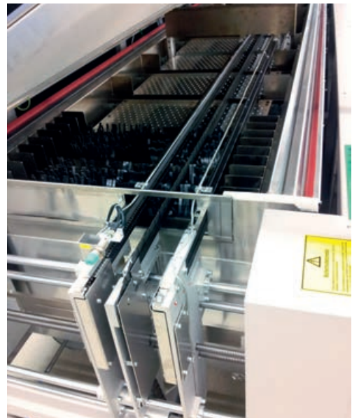
Reflow-Ofen: Die Stabilität der Prozessparameter je nach Position eines Boards im Ofen muss kontrolliert werden
