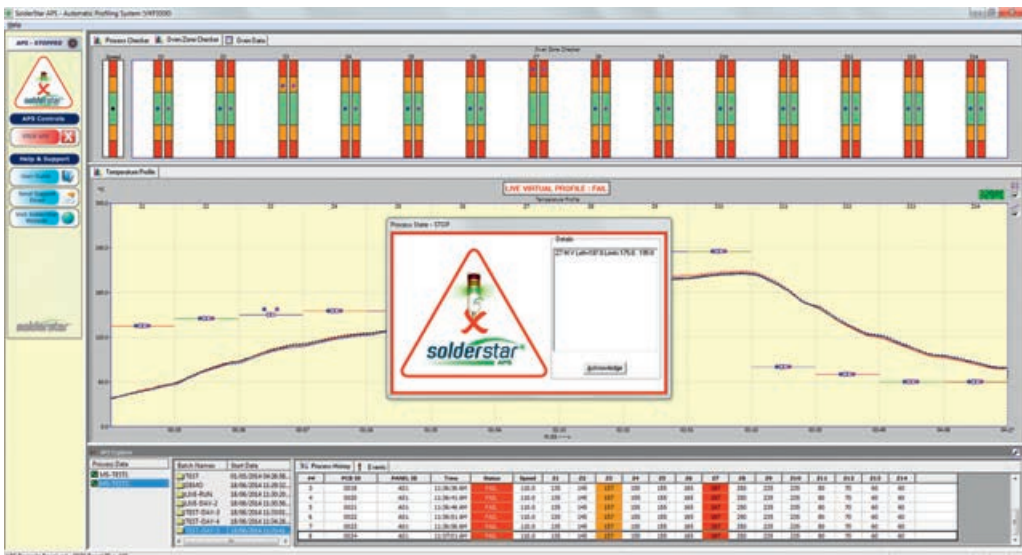
Software für effizientes thermisches Profiling ohne Zeitverluste: Hier wird eine Warnung in der Ofenzone Z7 wegen Maschinenfehlers gegeben
