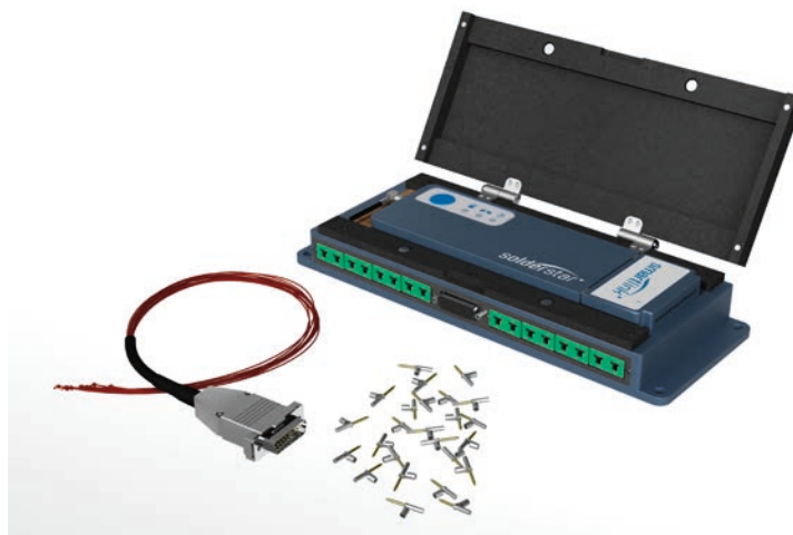
Fig. 2 - Strumento flessibile per l'utilizzo con le macchine multi-onda, il MultiWave PRO può essere collocato su differenti sistemi per l'analisi delle prestazioni degli ugelli dei multi-onda
